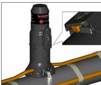
13. Voltooid verbindingset. Zorg ervoor dat het vergrendelingsmechanisme in vergrendelde positie is.
