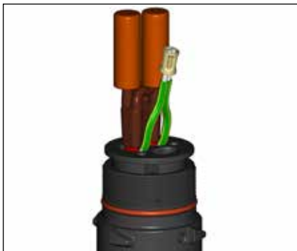
11. Schuif de siliconen kappen over de krimpisolatoren.
