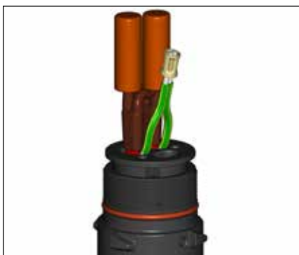
11. Schuif de siliconen kappen over de krimpisolatoren.
