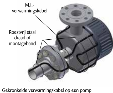
Afbeelding G: Voorbeeld pompdetail
